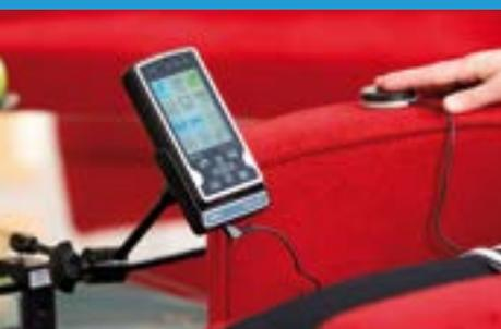
Émetteur intégrant un téléphone mobile adapté aux personnes handicapées, se pilotant directement par son écran tactile ou par défilement contacteur(s) et joystick FRE. IR et Radio, interface flexible et paramétrable en fonction des besoins et des préférences de l'utilisateur.
